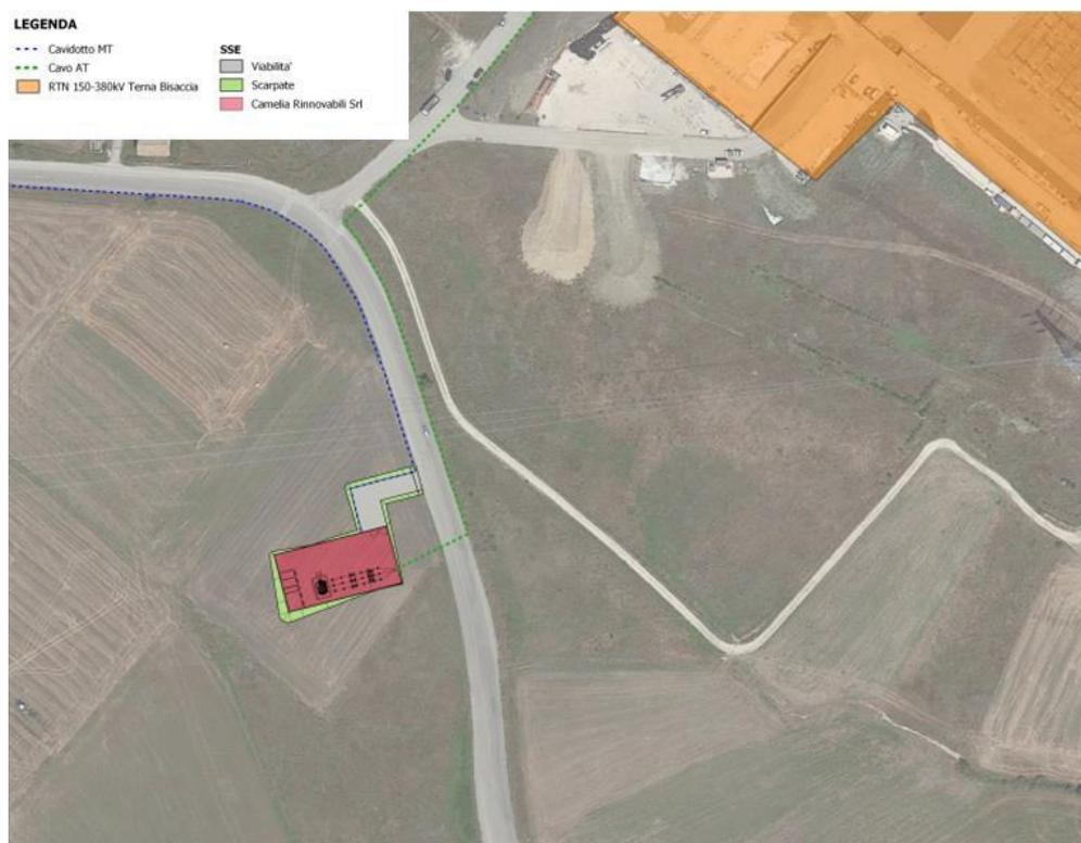
**Figura 1 – Stralcio con indicazione della posizione della stazione utente Camelia Rinnovabili Srl, rispetto alla stazione Terna di smistamento a 150 kV**
