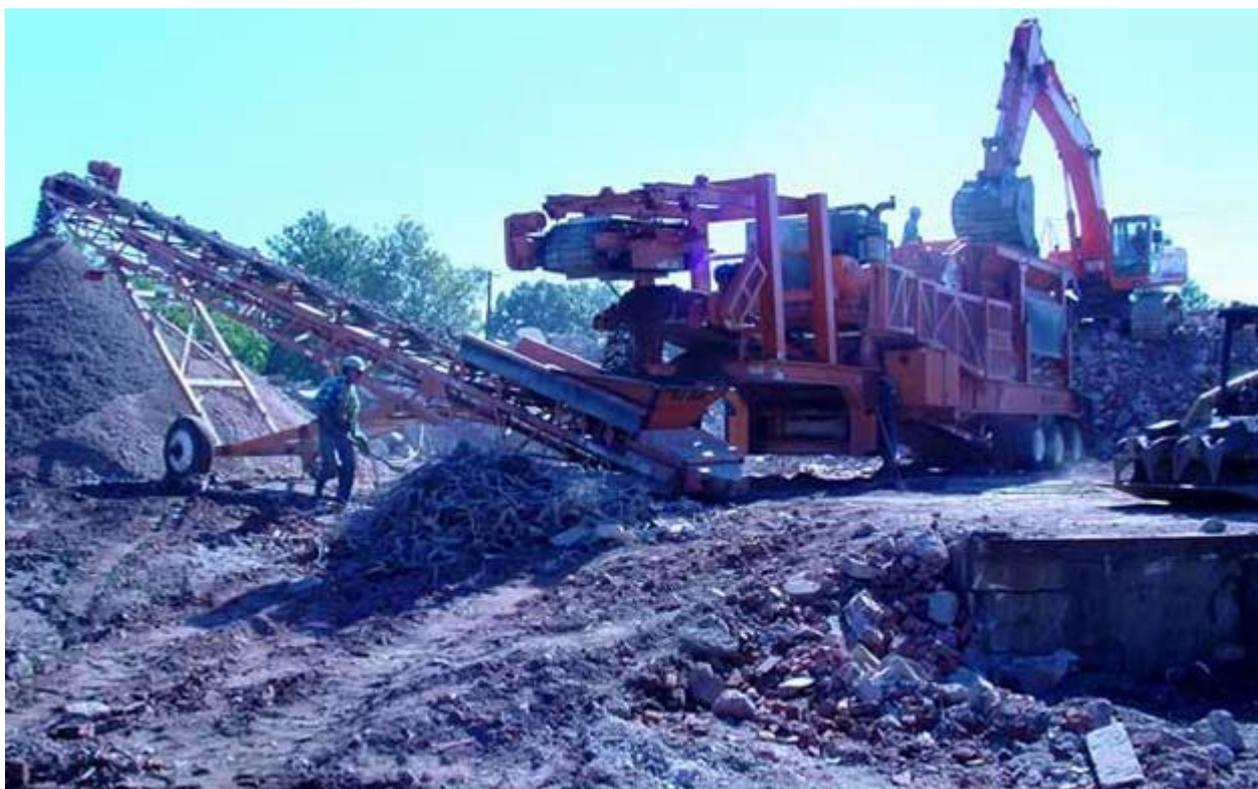
Figura 14: impianto mobile di valorizzazione
