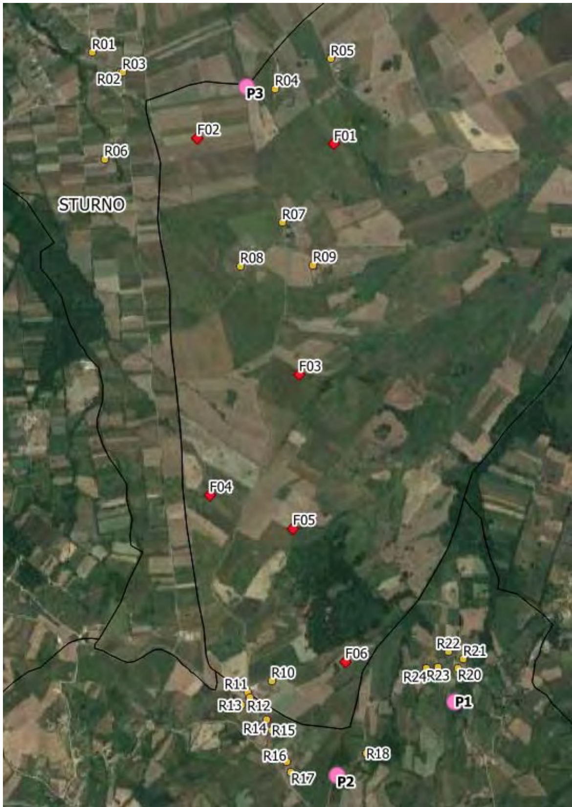
Figura 2: stralci con localizzazione dei ricettori (Ri), della postazione di misura (Pi) e degli aerogeneratori di progetto (F0i)
