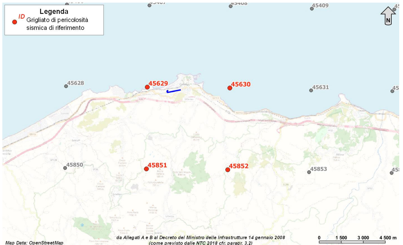
Figura 22 – Griglia di riferimento per il settore oggetto di studio, riprodotto in scala 1:150000, con individuazione dell'opera in progetto (in blu) e dei punti del grigliato scelti (in rosso).
