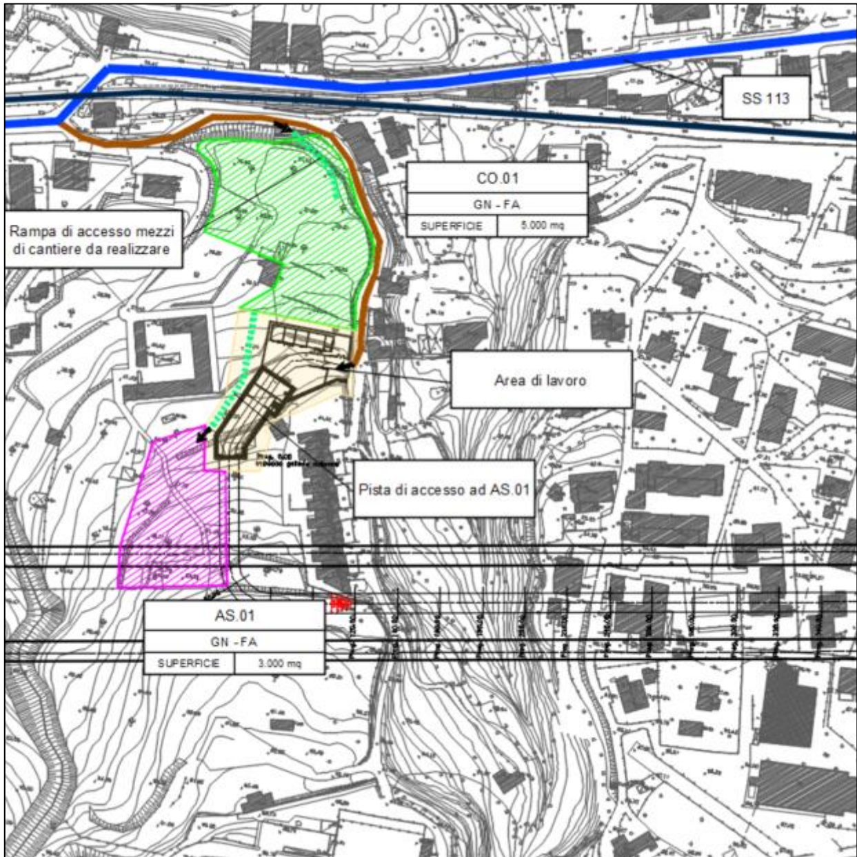
Figura 6-3 - Viabilità per il transito dei mezzi di trasporto per la zona di valutazione
