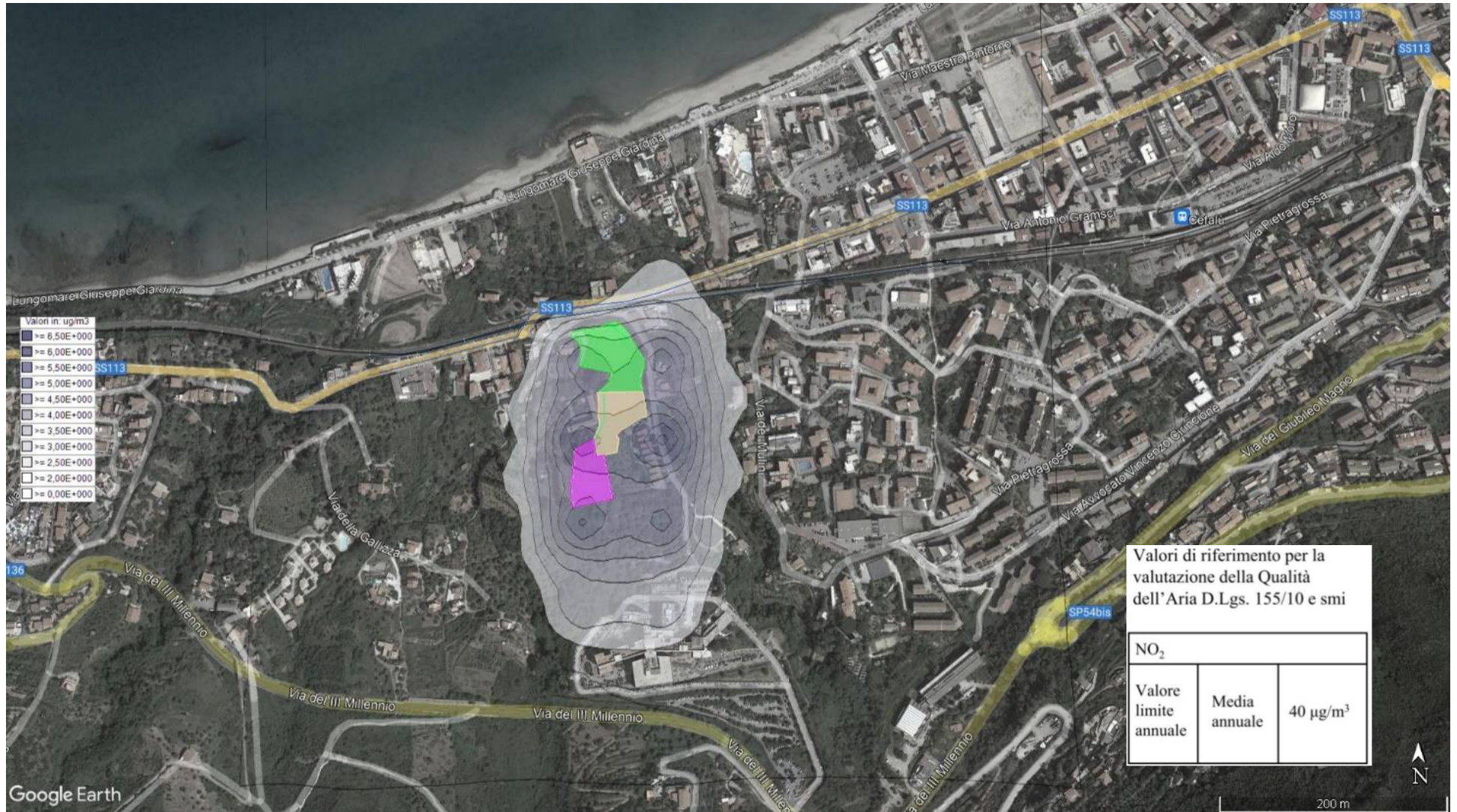
Concentrazioni di NO x dovute alle emissioni dei mezzi d'opera per AS25 e CO04
