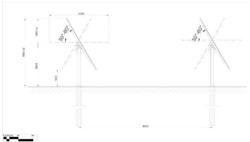
Figura 41 – Profilo longitudinale struttura
