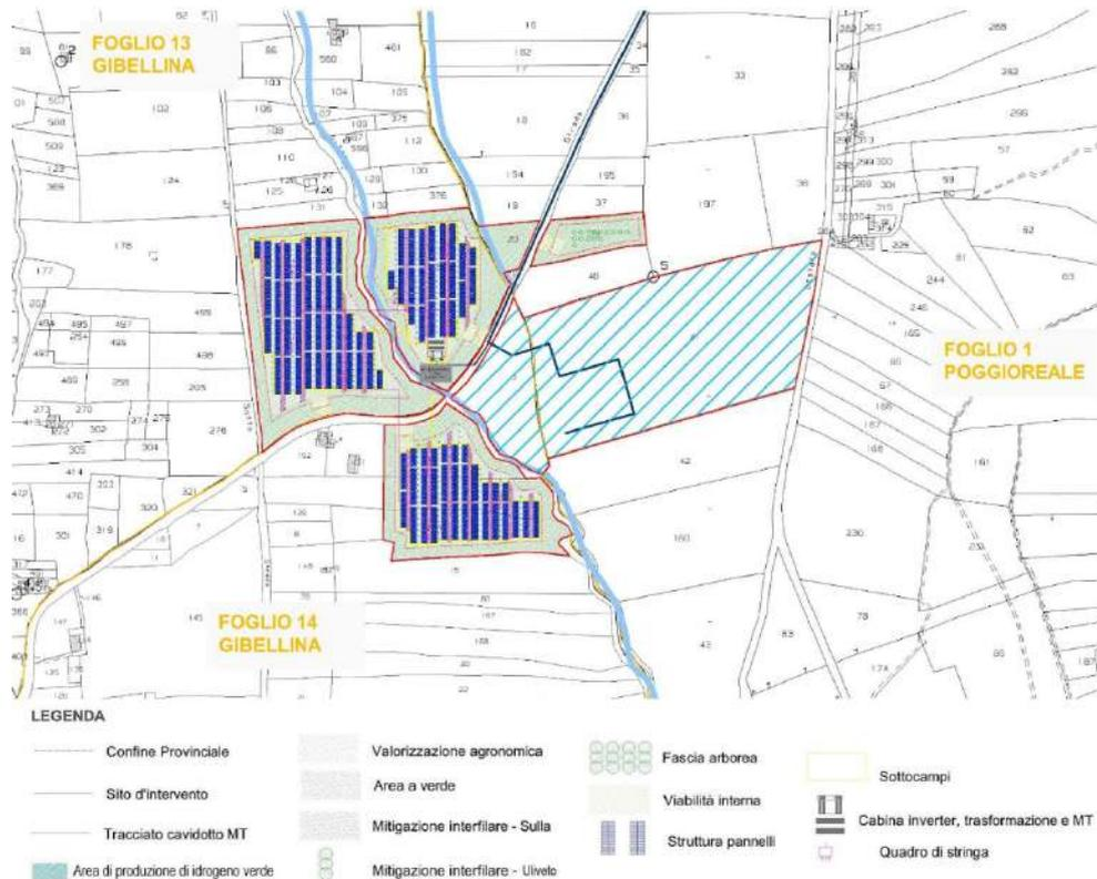
Figura 45 F – Layout dell'area di impianto e produzione di idrogeno ricadente nei territori di Gibellina (TP) e Poggioreale - **Contrada Abita di Sopra** su base catastale
