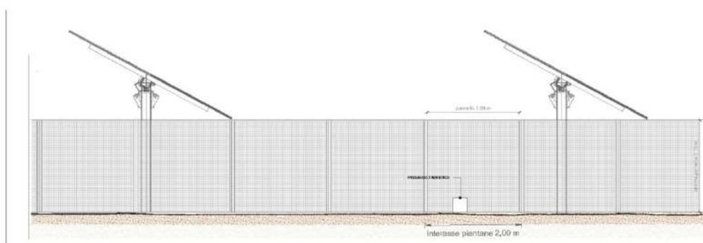
Figura 48 – Prospetto recinzione perimetrale senza mitigazione
