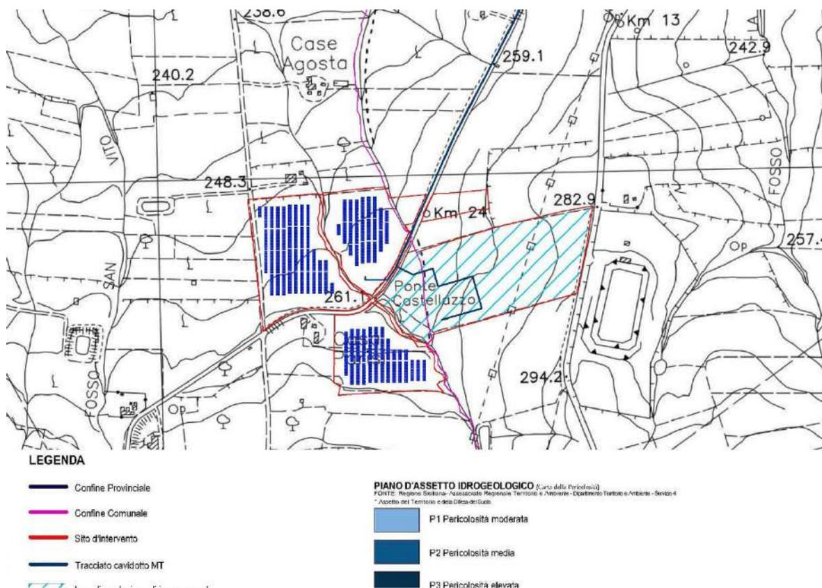
Figura 23 - Carta della pericolosità idraulica dell'area di impianto e produzione di idrogeno ricadente nel territorio di Poggioreale (TP – Contrada Casuzze-Abita di Sopra) [Fonte Regione Sicilia P.A.I.]
