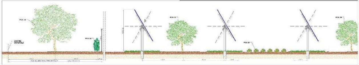
Figura 49 – Sezione mitigazione dell'impatto visivo
