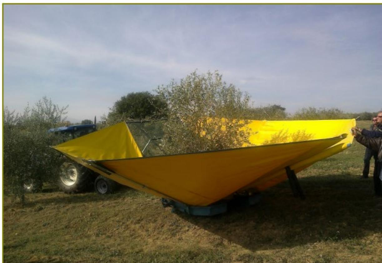
Fig. 35 - Raccolta meccanizzata con braccio vibratore e telaio intercettatore ad ombrello rovesciato.
