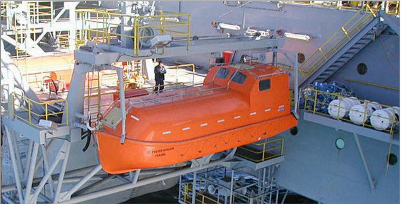
**Figura 3.17 - Esempio di scialuppa di salvataggio da piattaforma, tali scialuppe possono contenere da 50 a 100 persone (fonte: [www.nauticexpo.it](http://www.nauticexpo.it))**
