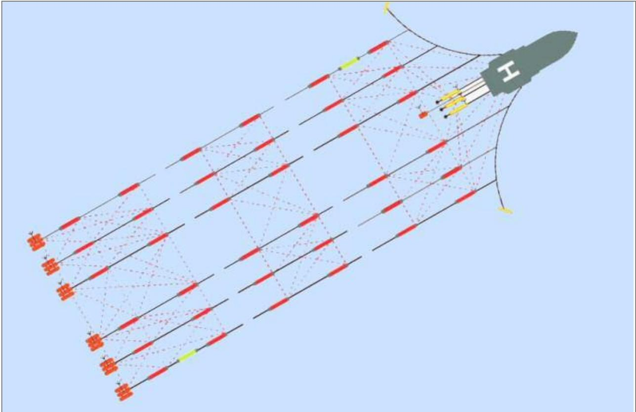
**Figura 3.8 - Configurazione di un possibile array con un volume totale degli airgun di 3090 pollici cubici (circa 50,7 litri); (fonte: [www.acsonline.org](http://www.acsonline.org))**
