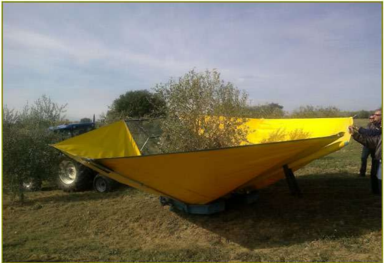
Fig.54 - Raccolta meccanizzata con braccio vibratore e telaio intercettatore ad ombrello rovesciato.
