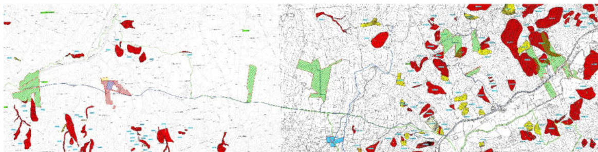
Figura 28 - Carta dei dissesti dell'area interessata dal cavidotto di connessione [Fonte Regione Sicilia P.A.I.]
