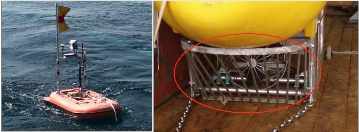
Figura 6.1 – A sinistra: esempio di Boa di coda, fissata all'estremità del cavo sismico (fonte: www.jamstec.go.jp ). A destra: esempio di dispositivo che esclude la possibilità di intrappolamento delle tartarughe marine, la struttura aggiunta è evidenziata con un cerchio rosso (fonte: www.ketosecology.co.uk )
