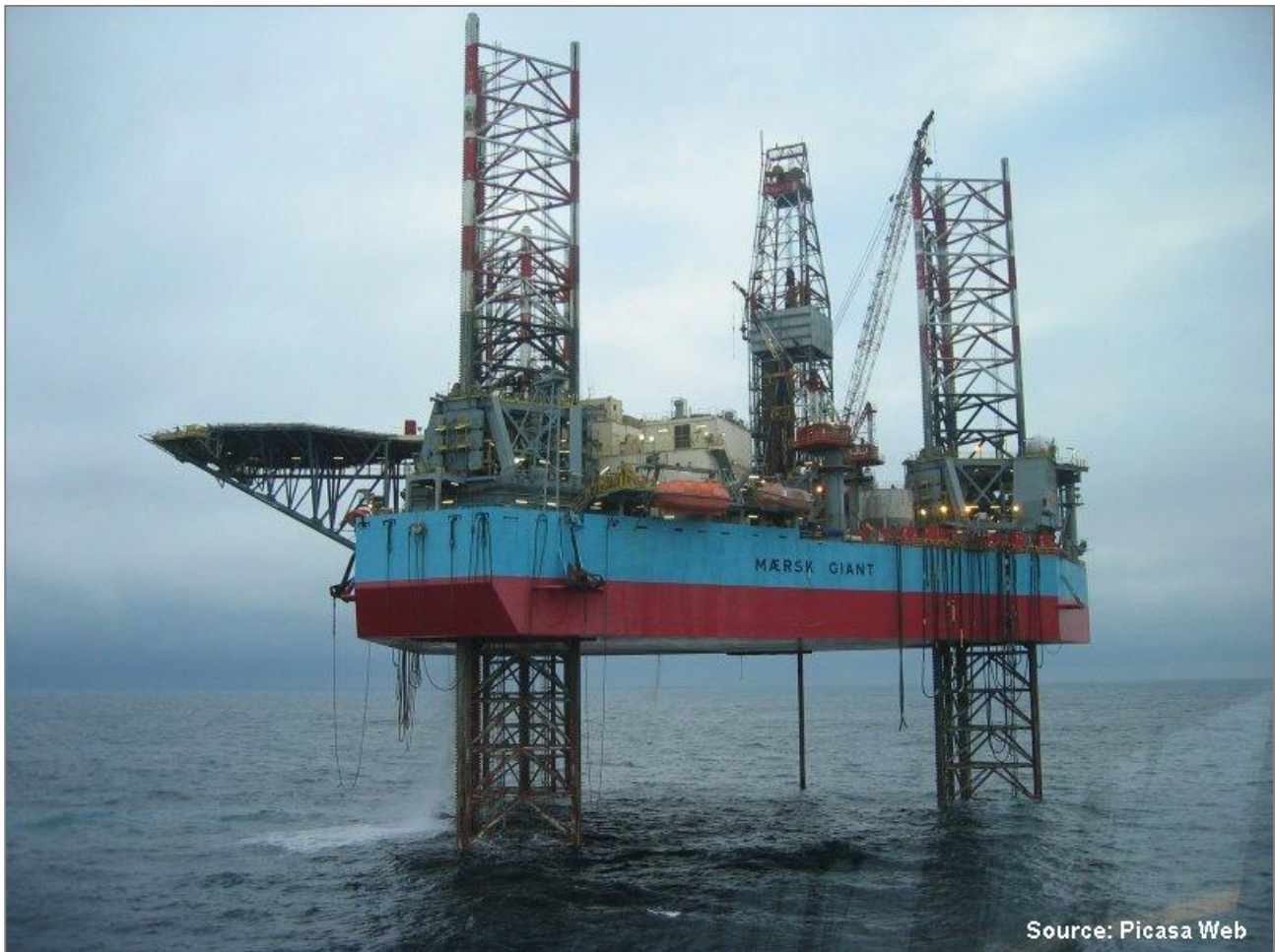
Figura 3.44 - Esempio di piattaforma mobile o jack-up (fonte: www.isleofbarra.com )
