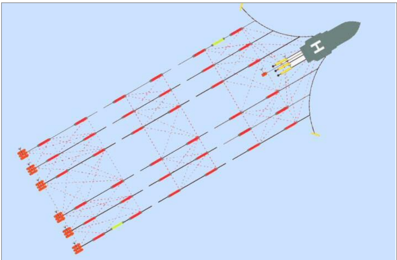
Figura 3.39 - Configurazione di un possibile array con un volume totale degli airgun di 3090 pollici cubici (circa 50,7 litri); (fonte: www.acsonline.org)
