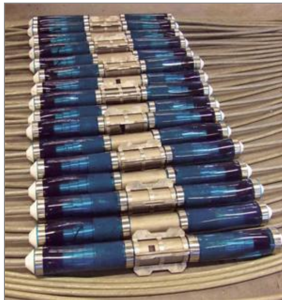
Figura 3.40 - Esempio di una serie di idrofoni usati nella prospezione sismica in mare (fonte: www.oilonline.com )
