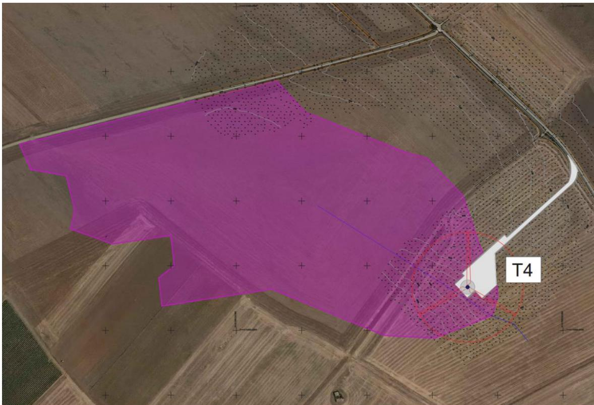
Figura 3.4 Bacino idrografico relativo all'asta idrica in prossimità della torre T4
