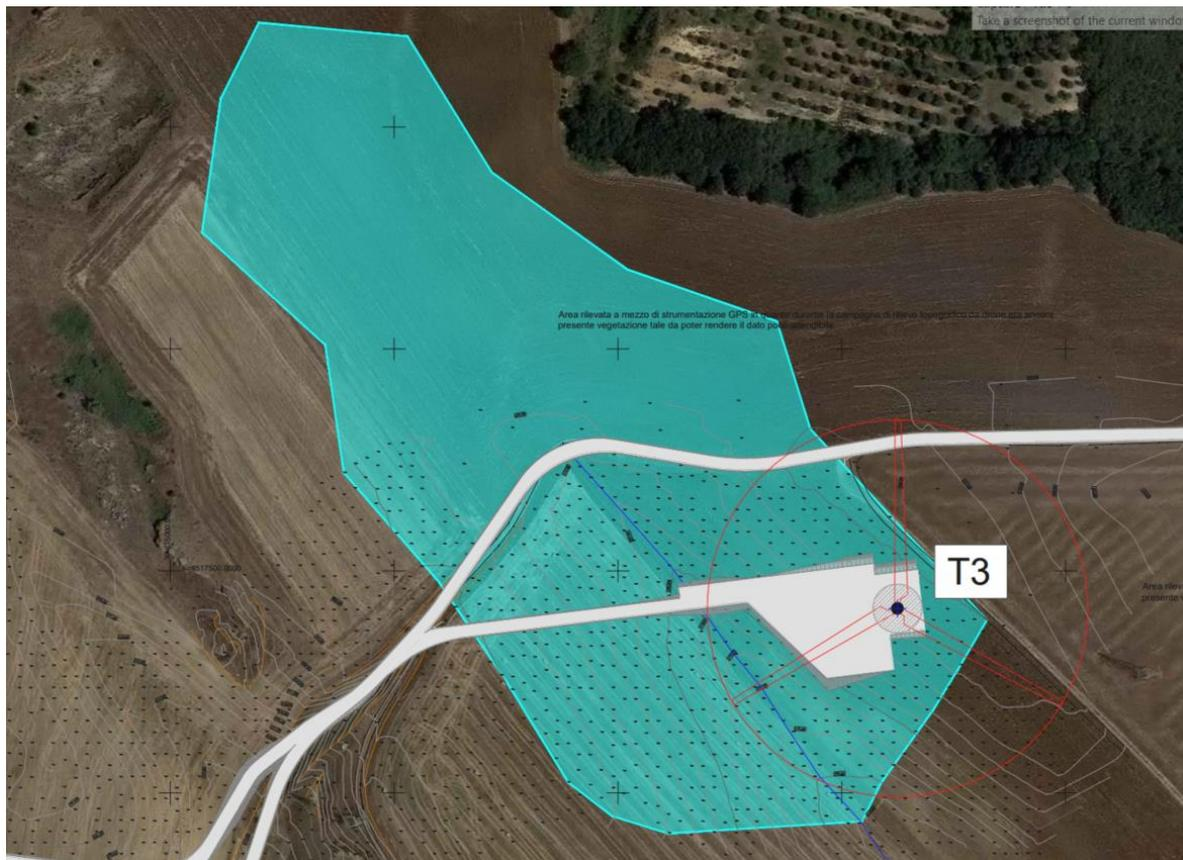
Figura 3.3 Bacino idrografico relativo all'asta idrica in prossimità della torre T3
