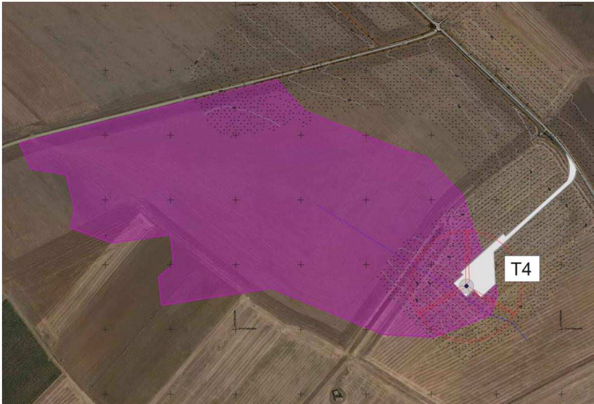
Figura 3.2 Bacino idrografico relativo all'asta idrica in prossimità della torre T4
