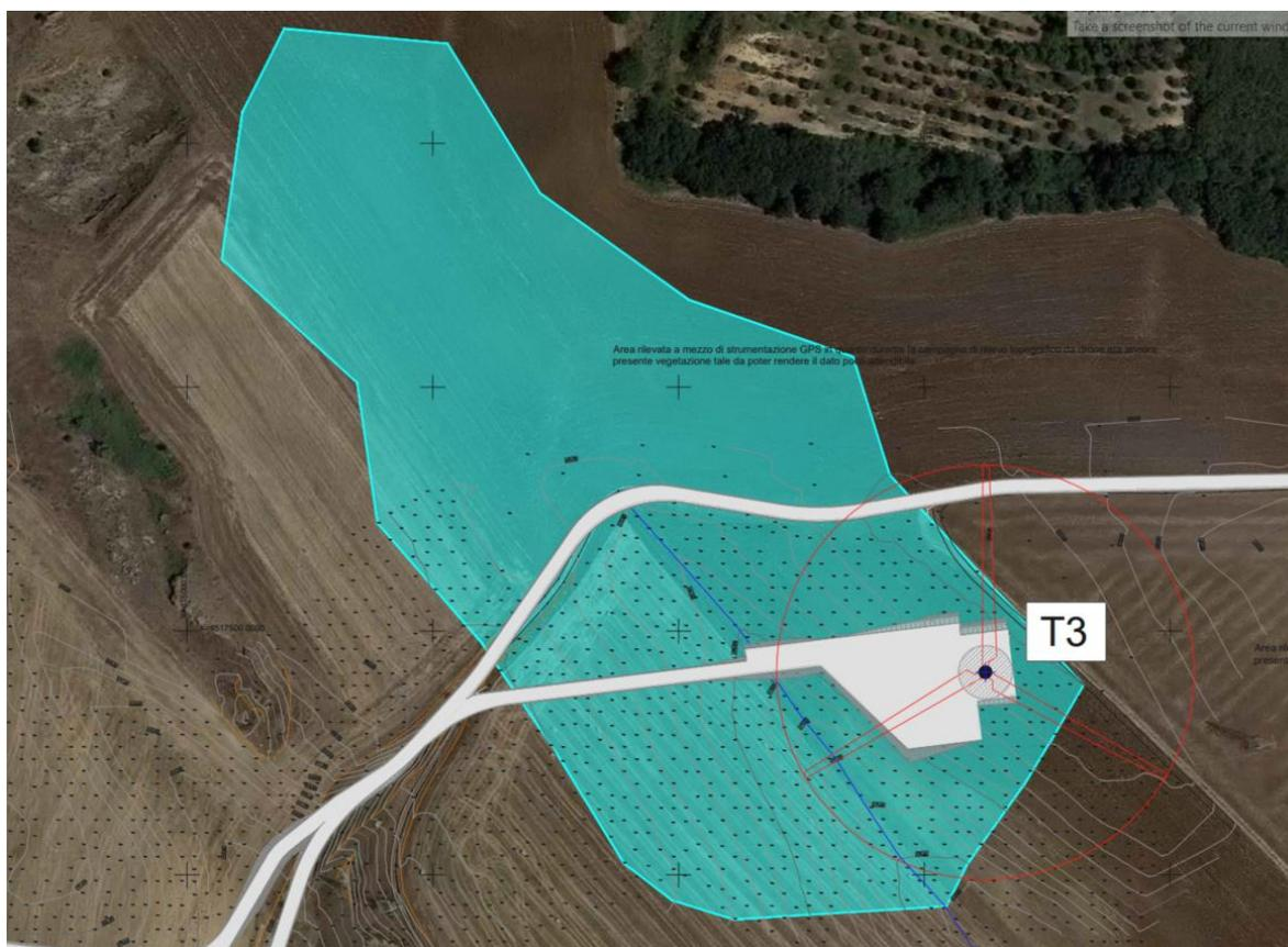
Figura 3.1 Bacino idrografico relativo all'asta idrica in prossimità della torre T3
