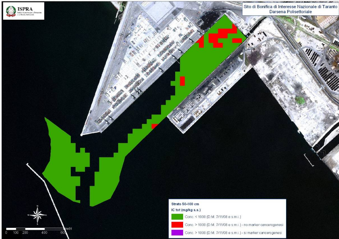
Figura 21. Elaborazione geostatistica delle concentrazioni di Idrocarburi Totali rilevate nello strato 50-100 cm
