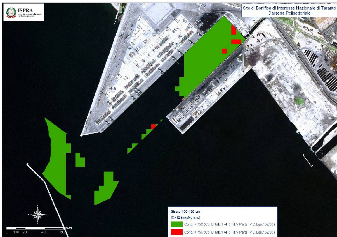
Figura 25. Elaborazione geostatistica delle concentrazioni di IC&gt;12 rilevate nello strato 100-150 cm
