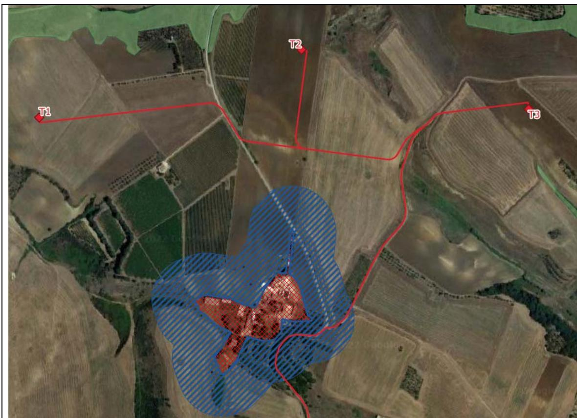
Figura 2 – Interferenza tra layout elettrodotti a 36 kV e area di rispetto di siti storico culturali
