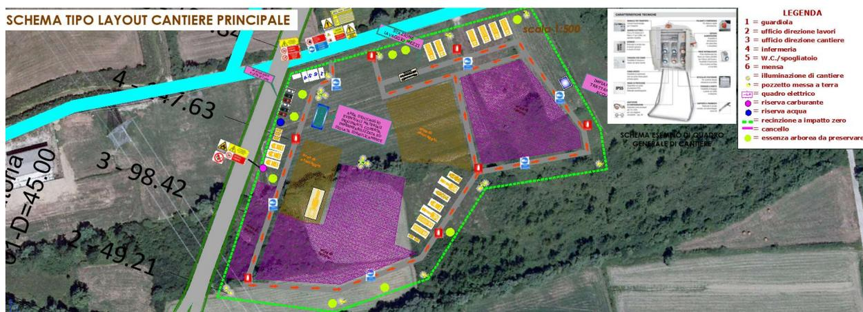
Figura 24 - SS.260 – Layout schema tipo cantiere principale
