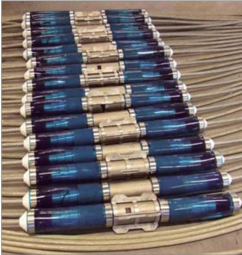
Figura 3.9 - Esempio di una serie di idrofoni usati nella prospezione sismica in mare (fonte: [www.oilonline.com](http://www.oilonline.com))
