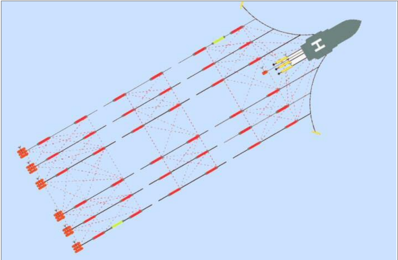
Figura 3.42 - Configurazione di un possibile array con un volume totale degli airgun di 3090 pollici cubici (circa 50,7 litri); (fonte: www.acsonline.org )
