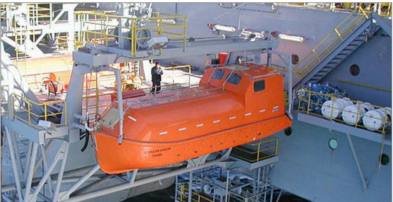
Figura 3.51 - Esempio di scialuppa di salvataggio da piattaforma, tali scialuppe possono contenere da 50 a 100 persone (fonte: www.nauticexpo.it )
