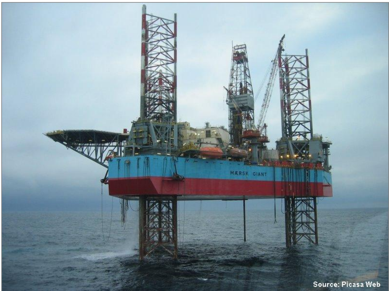
Figura 3.47 - Esempio di piattaforma mobile o jack-up (fonte: www.isleofbarra.com )
