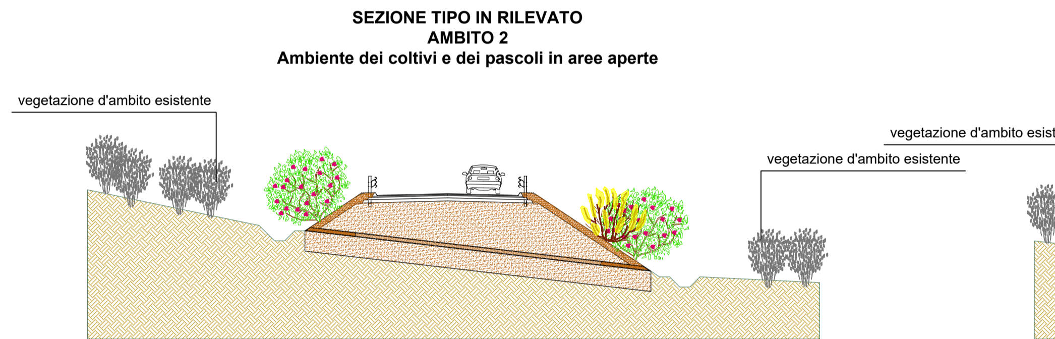
SEZIONE TIPO IN RILEVATO CON TERRA RINFORZATA
