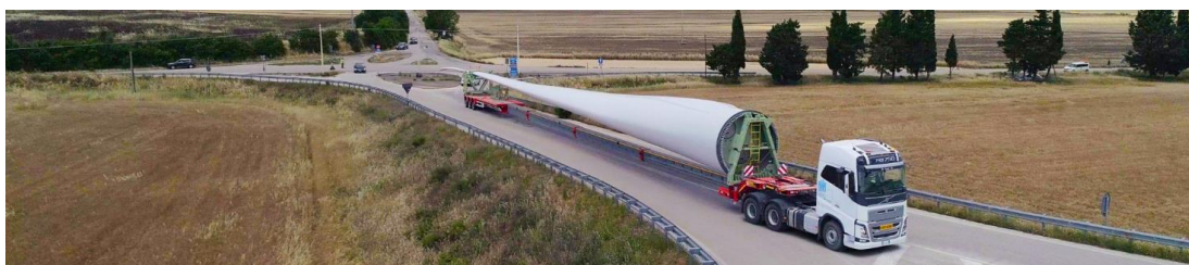
Figura 16 – Esempio di trasporto con SWC (Super Wing Carrier)
