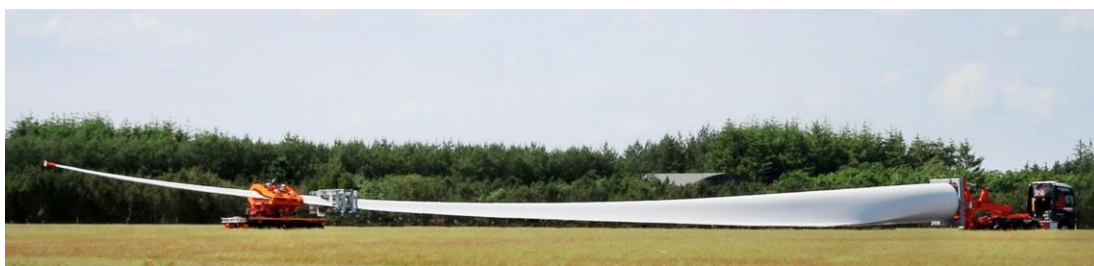
Figura 17 – Esempio di trasporto con "RBTS" (Rotor Blade Transport System)
