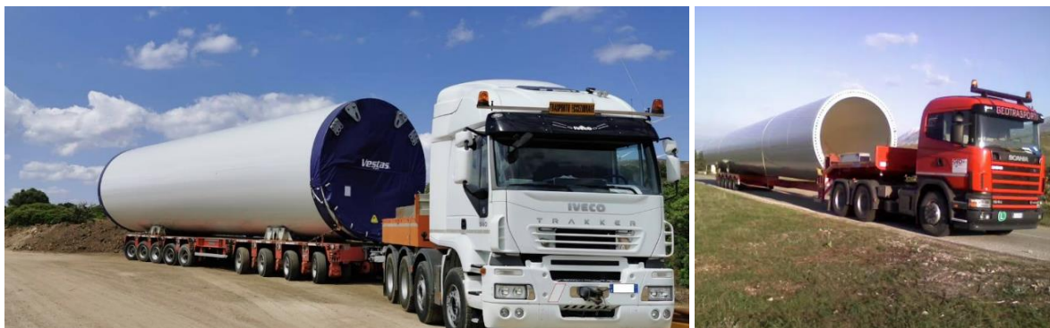
Figura 19 – Esempio di trasporto con convogli a pianale allungabile per conchi di torre
