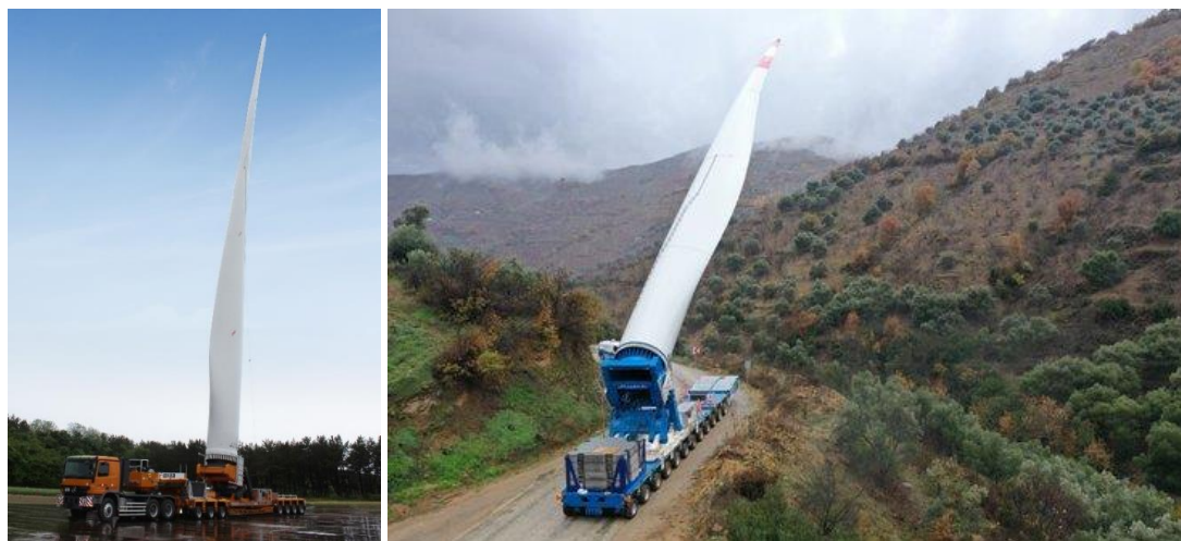
Figura 18 – Esempio di trasporto con Blade Lifter Trailer
