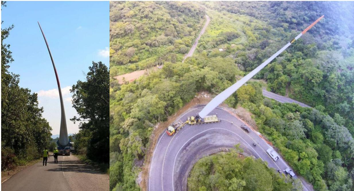
Figura 13 Esempio di trasporto con Blade lifter trailer
