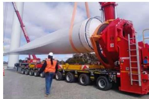
Figura 47 - Sistemi di trasporto pale: Blade Lifter Device
