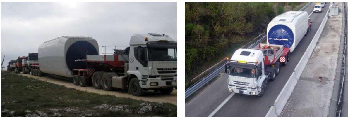
Figura 49 – Esempio di trasporto Nacelle
