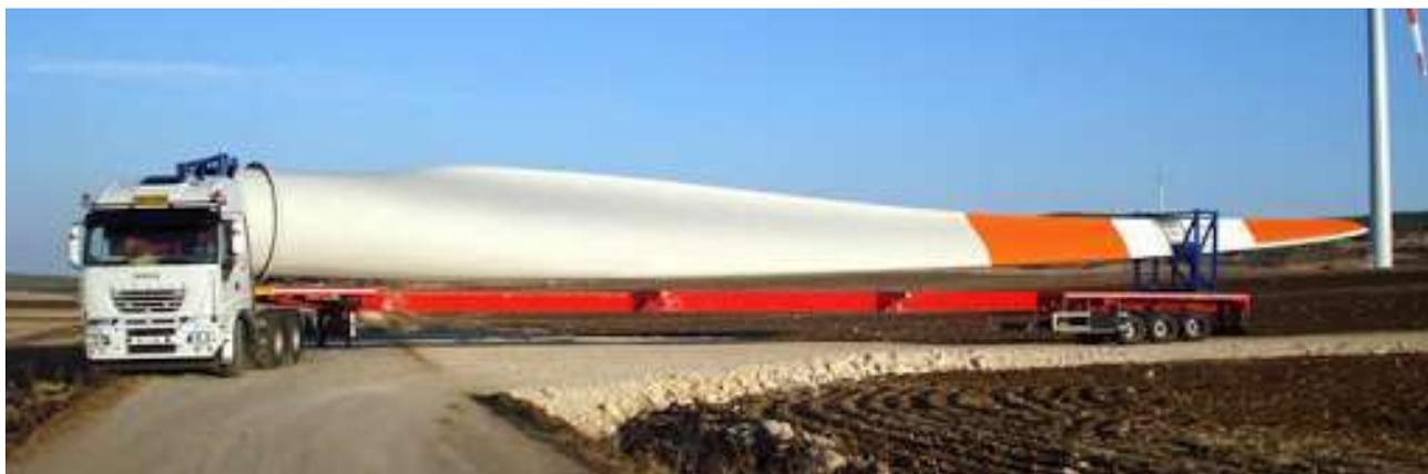
*Figura 52 - Soluzione tipo del trasporto delle pale e pista di nuova realizzazione tipo per l'accesso alla turbina*
