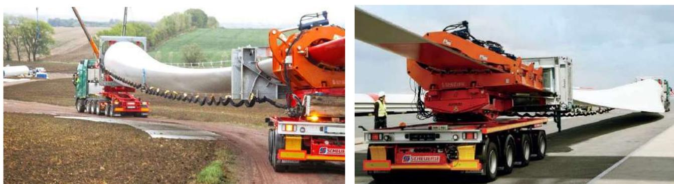
Figure 46 - Esempio di trasporto pale tipologia RBTS “Rotor Blade Transport System”
