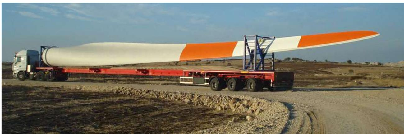
*Figura 53 - Soluzione tipo del trasporto delle pale e adeguamento in curva tipo sulla viabilità esistente*
