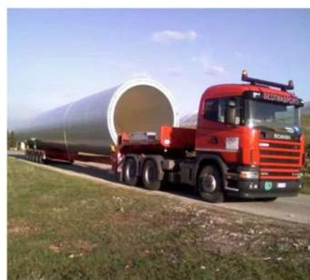
Figura 48 - Esempio di trasporto con convogli a pianale allungabile per conici di torre
