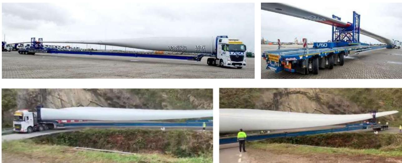
Figure 45 - Esempio di trasporto pale con tipologia SWC “Super Wing Carrier”
