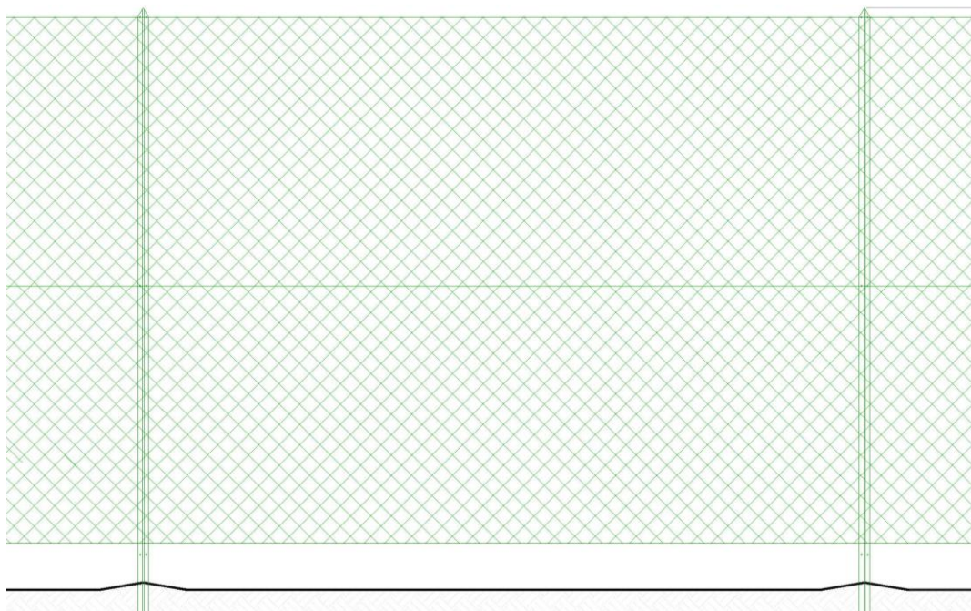
Figura 33: Particella recinzione perimetrale con apertura inferiore (20-30 cm).
