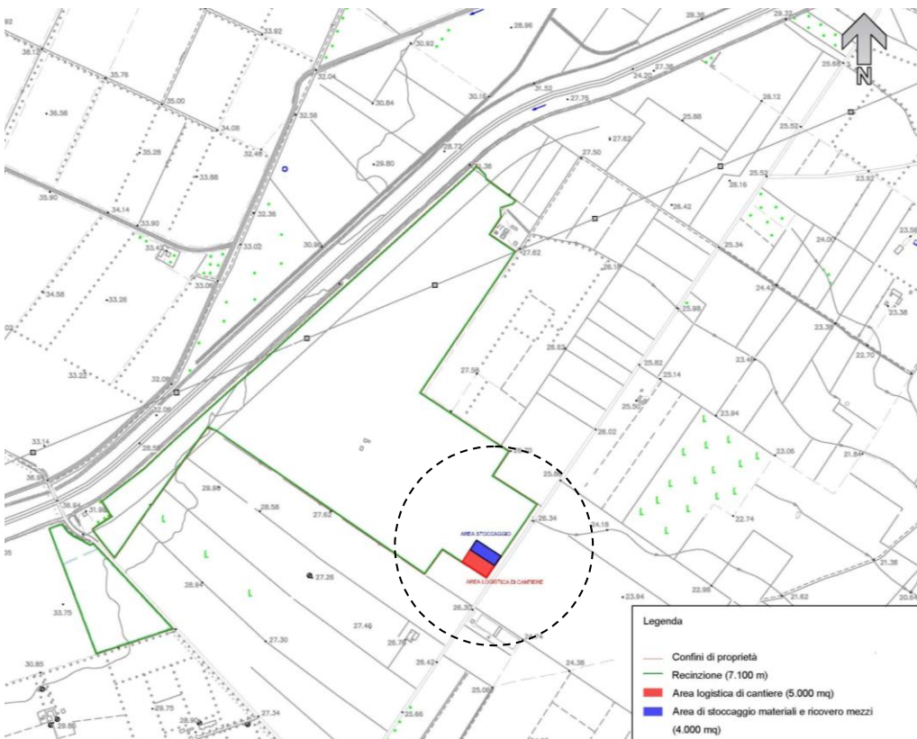
Figura 10: Collocazione area logistica di cantiere e area di stoccaggio nel sito di intervento.
