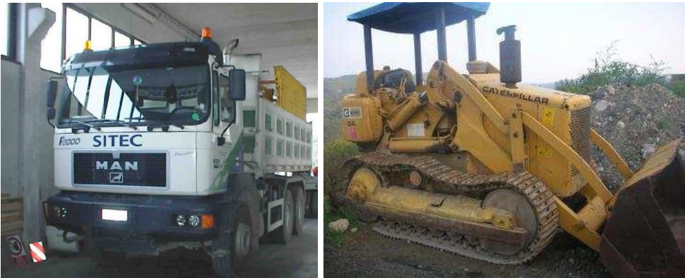
Figura 6: Esempi di macchine operatrici impegnate per la costruzione dell'impianto (Autocarro e Pala cingolata).
