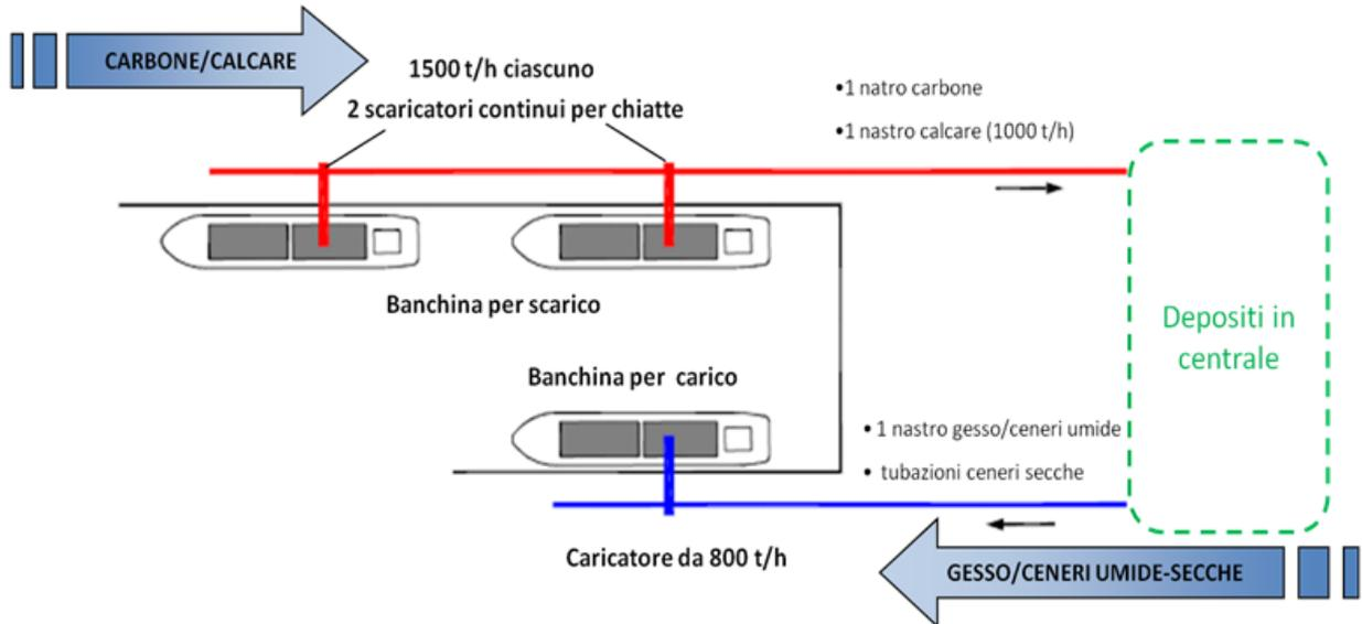
Le banchine saranno collegate con la centrale attraverso tre nastri in gomma, due per il trasferimento rispettivamente di carbone e calcare verso i depositi di centrale, il terzo per il trasferimento di gesso e ceneri umidificate dai depositi in centrale verso la banchina, per il successivo caricamento sulle chiatte. Tutti i nastri delle banchine saranno chiusi.
