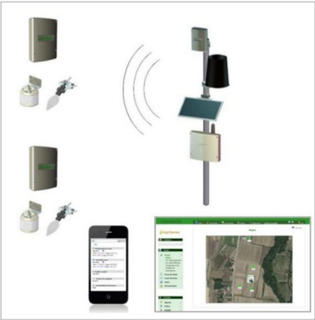
Figura n.7: Stazione principale e sensori meteo climatici.
