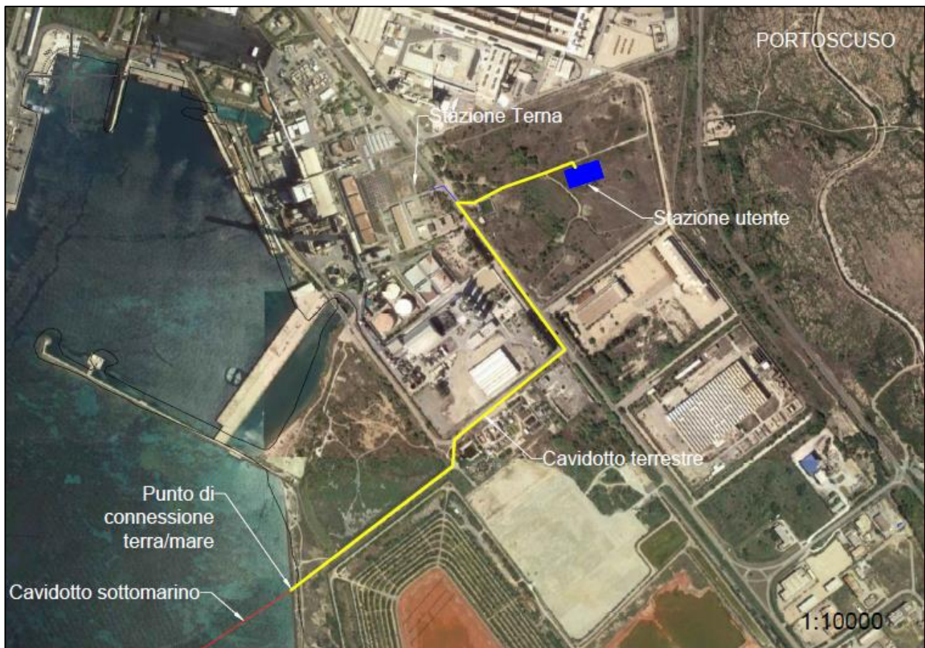
Figura 1-5 – Percorso terrestre dei cavi su ortofoto
