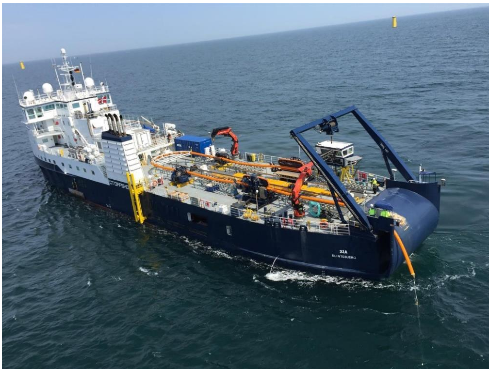
Figura 2-29 – Illustrazione dell'installazione del cavo (Fonte: Offshore Gode-wind)
