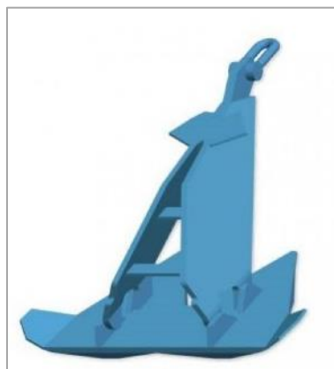
Figura 2-5 – Esempio di ancora con trascinamento
