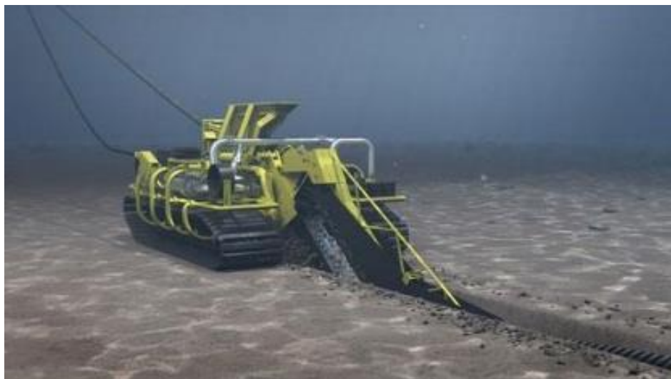
Figura 2-15 – Sistemi protezione dei cavi per interrimento
