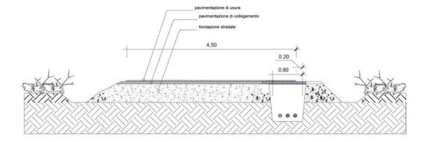
**SEZIONE TIPO- Cavidotto interrato**
