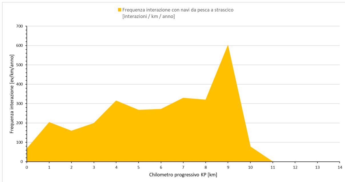
Figura 3.59: Frequenza interazione con cavidotti per imbarcazioni adibite alla pesca a strascico, caratterizzato per KP di cavidotto
