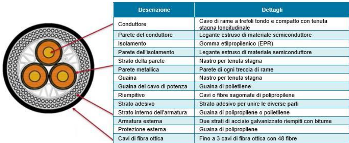
Figura 2.8: Esempio di cavo di interconnessione
