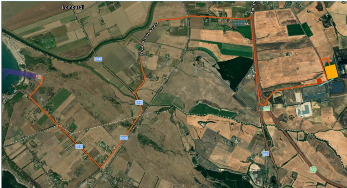
Figura 2.19: Percorso preliminare del cavidotto a 150 kV
