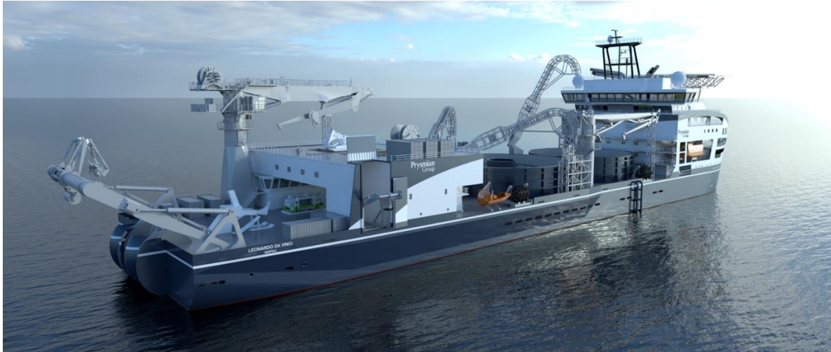
Figura 4.22: Esempio di nave posa cavi
