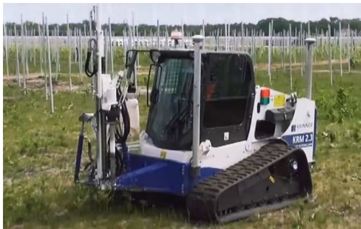
Fig. 5. Esempio di fissaggio delle strutture di supporto
