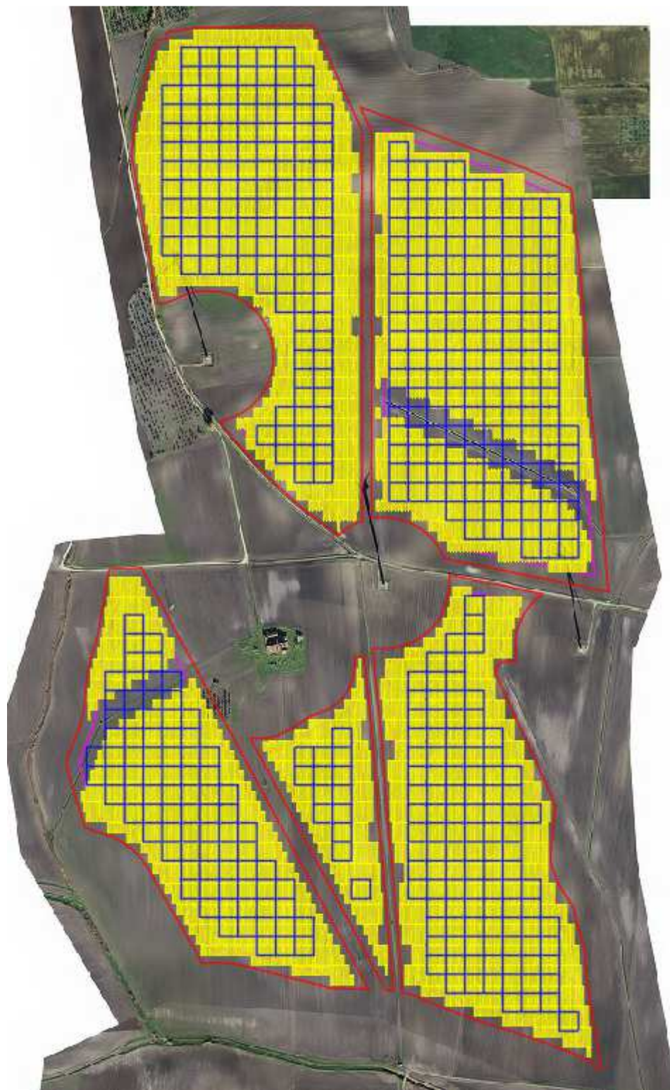
Fig. 7 - Area Impianto con maglie quadrate da 30*30 mt
