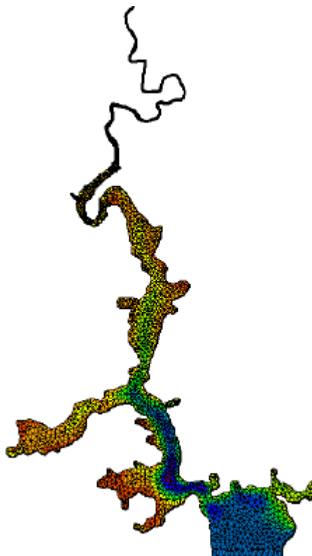
Esempio di griglia di calcolo per l'estuario Tamar, UK
