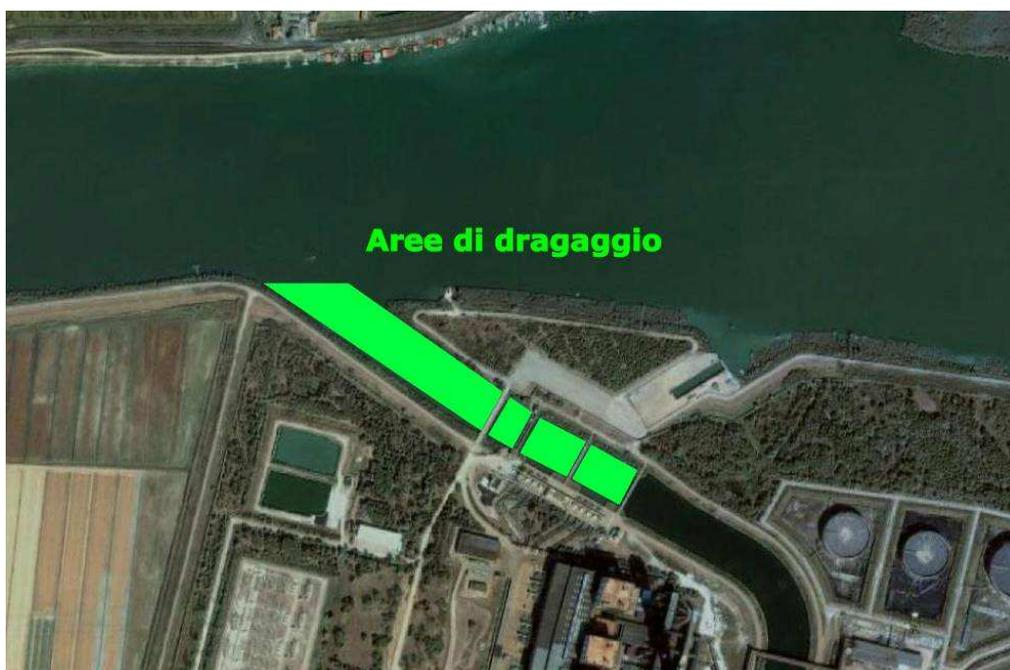
Figura 8 - Canale di presa a fiume e vasche di calma; in verde le aree da sottoporre ai dragaggi
