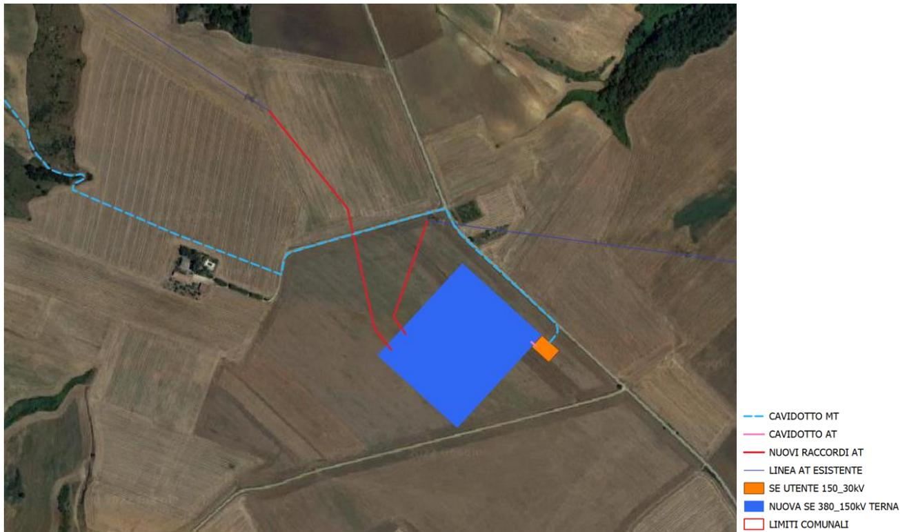
**Figura 2-3: Inquadramento delle opere di connessione su ortofoto**
