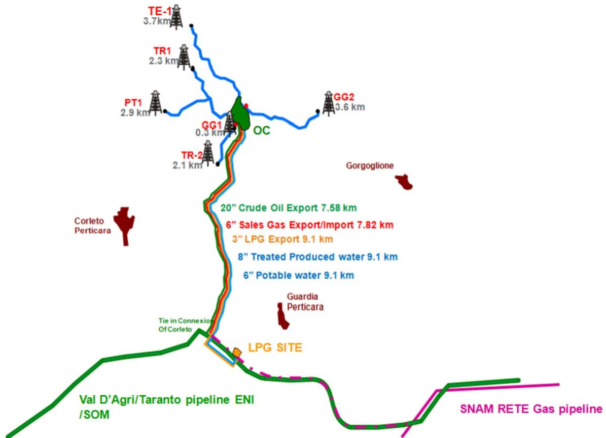
Figura 2-2 - Rappresentazione schematica delle infrastrutture Tempa Rossa
