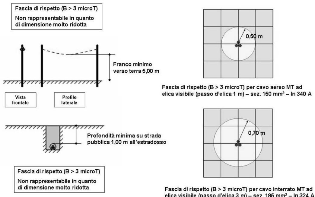
Figura 1: Induzione magnetica per cavi cordati ad elica (rif: modello "Elico" della piattaforma "EMF Tools")
