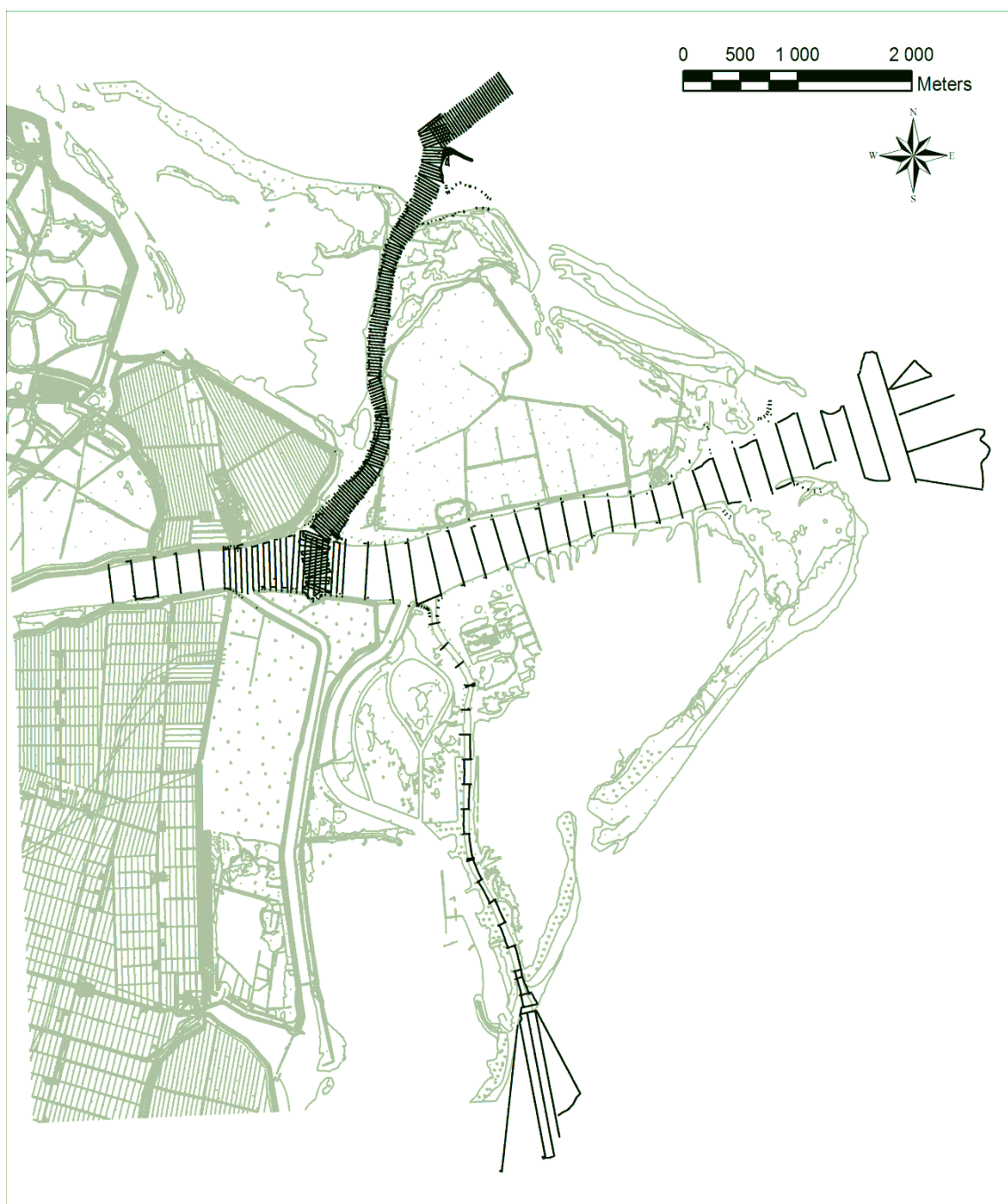
Figura 2-1 Estensione dei rilievi topografici e batimetrici (distribuzione dei punti quotati).
