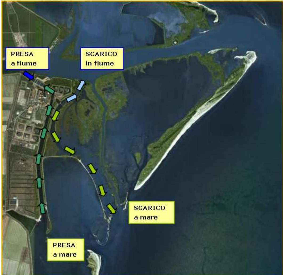
Figura 1 Vista da satellite dell'area in esame con indicazione del circuito delle acque di raffreddamento della centrale negli assetti di funzionamento mare – mare e fiume - fiume
