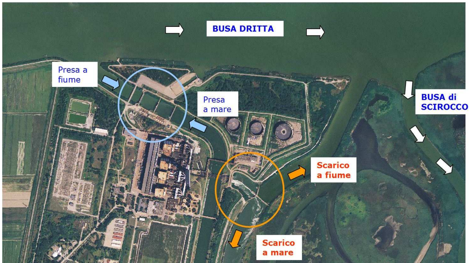
Figura 6 Dettaglio delle aree di presa e di scarico che rimarranno invariate nel futuro assetto a carbone (foto aeree da Rif. 17)
