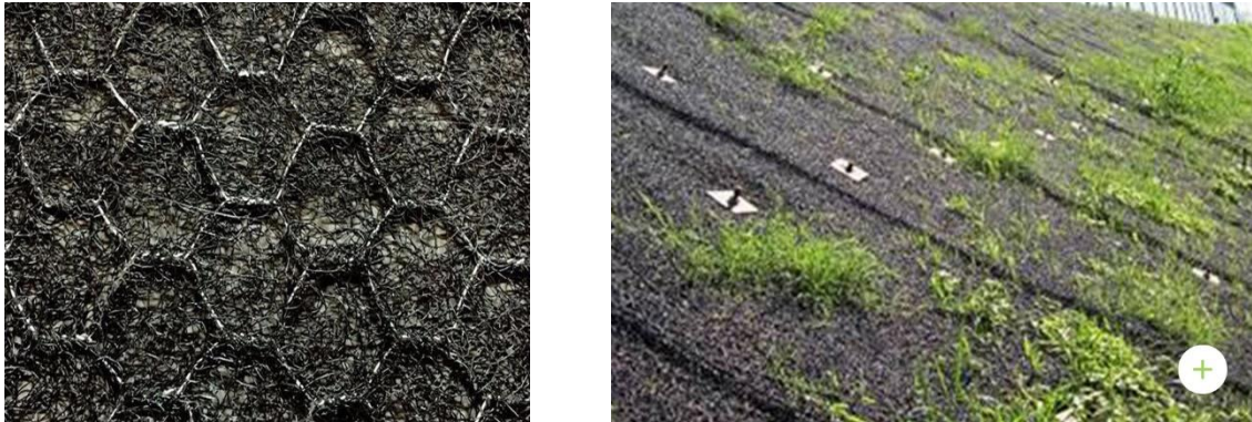
Figura 5.10. Geocomposito anterosivo accoppiato a rete metallica a doppia torsione
