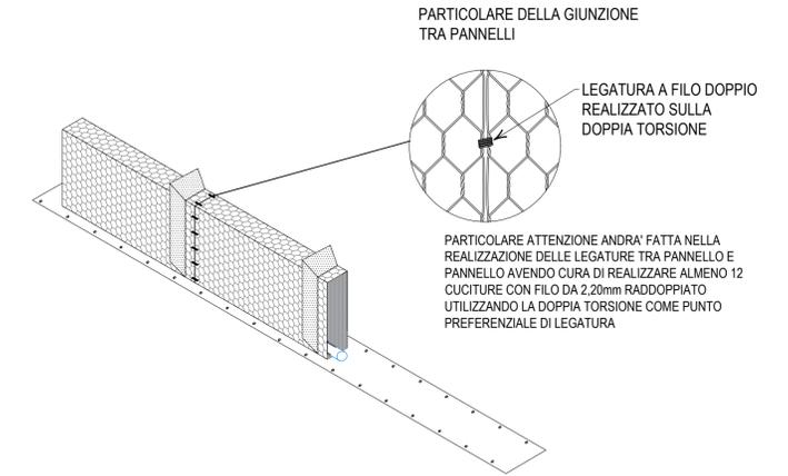
FASE 3 - RISVOLTO DELLE FASCETTE PROTETTIVE IN GEOTESSILE E ANCORAGGIO DELLA GUAINA IMPERMEABILE OCCHIELLATA ALLA BASE DEI PANNELLI DRENANTI
