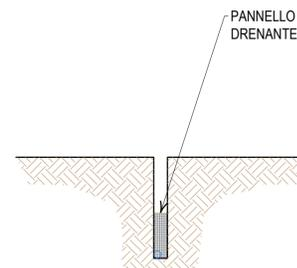
FASE 3 - RINTERRO DELLO SCAVO CON MATERIALE DI RISULTA DELLO SCAVO STESSO
