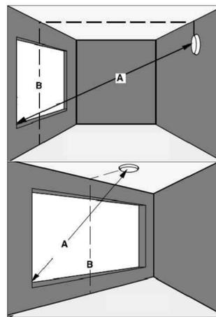
Soluzioni installative per il sensore di rottura dei vetri
