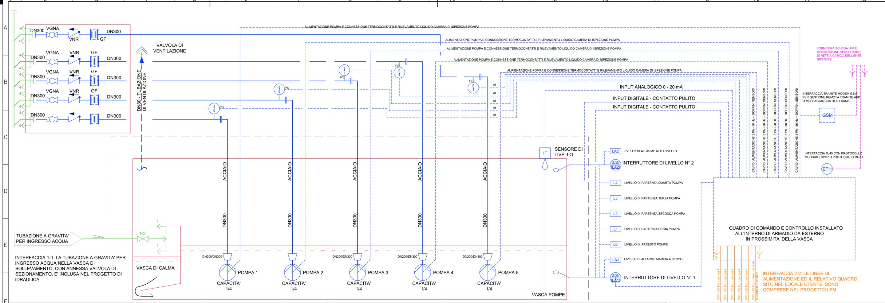
INTERFACCIA 1-1: LA TUBAZIONE A GRAVITA' PER INGRESSO ACQUA NELLA VASCA DI SOLLEVAMENTO, CON ANNESSA VALVOLA DI SEZIONAMENTO, E' INCLUSA NEL PROGETTO DI IDRAULICA
