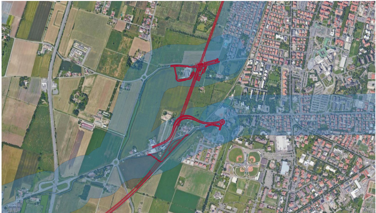
FIGURA 68 INTERFERENZA CON LA FASCIA DI RISPETTO DEL CAVO VIACAVA E DEL NAVIGLIO DEL TARÒ
