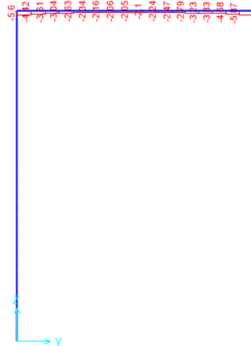
Figura 9.13 - Combinazione SLE quasi permanente – Valori di Sforzo Normale
