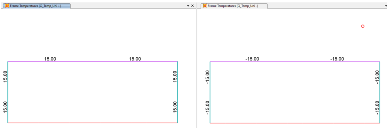
Fig. 11 – Q_Temp_Uni +/-: Forza termiche uniformi
