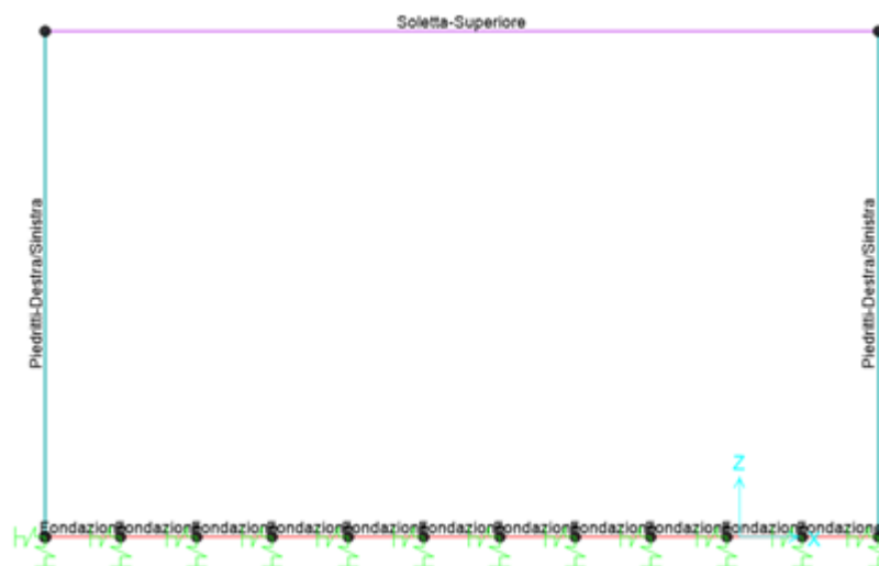
Fig. 32 – Modellazione unifilare dello scatolare
