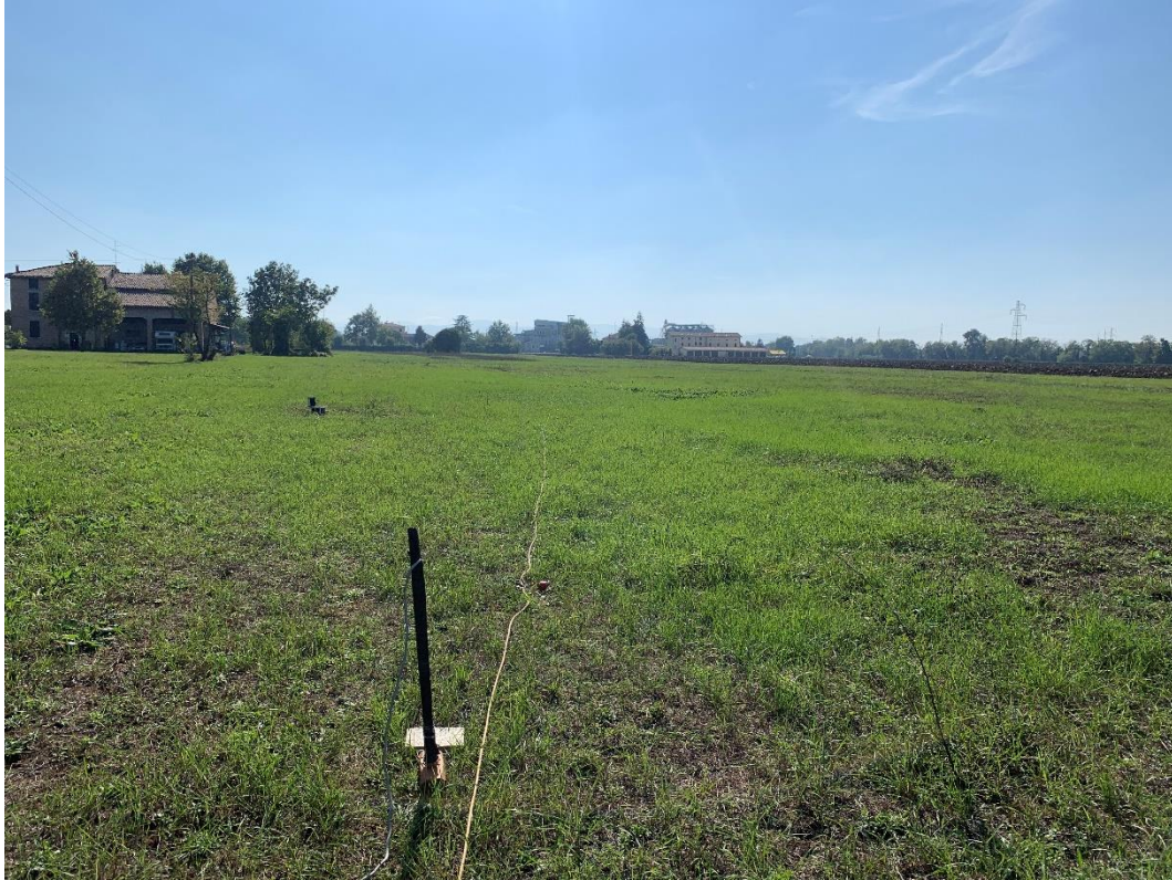
Figura 4.20: Foto relativa all'esecuzione della prova sismica MASW4.
