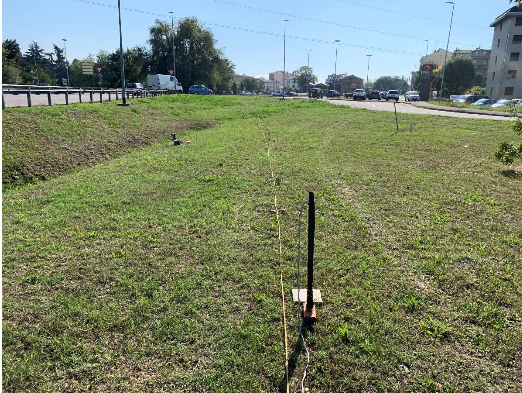
Figura 4.15: Foto relativa all'esecuzione della prova sismica MASW3.
