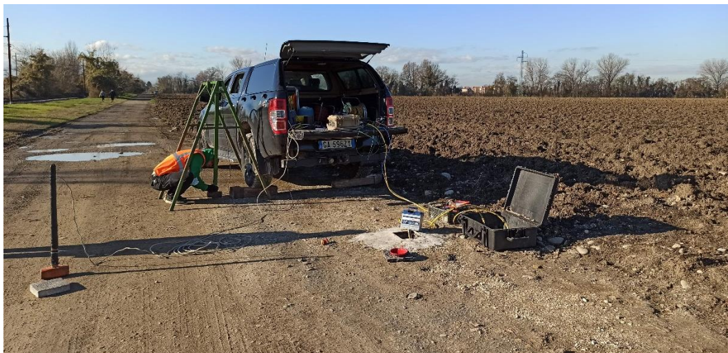
Figura 8.2: Foto relativa all'esecuzione della prova down-hole BH5.
