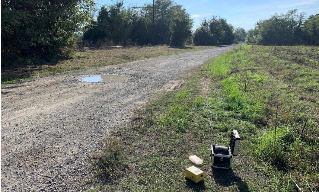
Figura 6.12: Foto relativa all'esecuzione della prova HVSR6.
