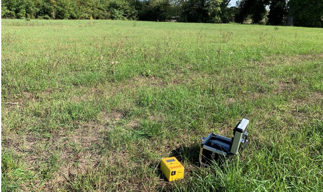
Figura 6.4: Foto relativa all'esecuzione della prova HVSR2.
