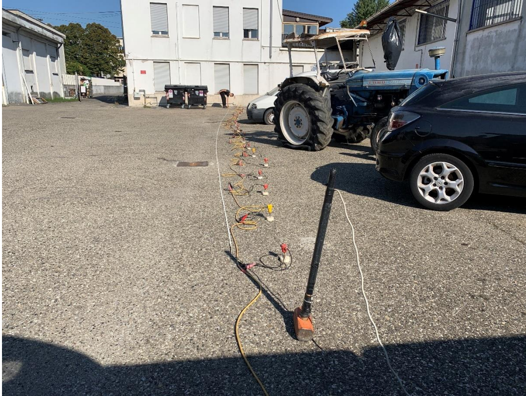
Figura 4.5: Foto relativa all'esecuzione della prova sismica MASW1.
