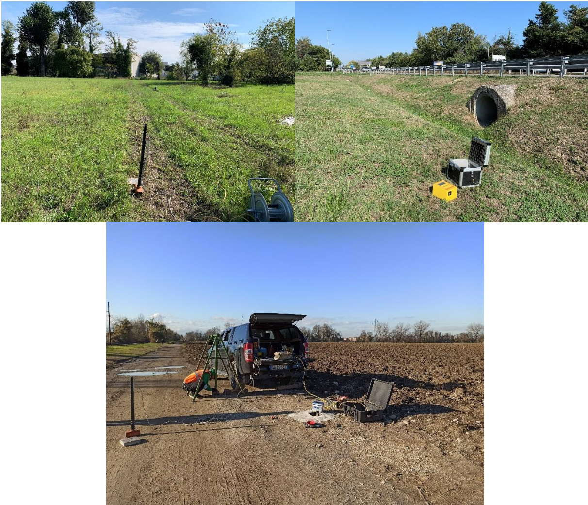
Figura 2.1: Strumentazione impiegata per le prove sismiche di superficie mediante metodologia MASW (in alto a sinistra) e HVSR (in alto a destra) e in foro (in basso).
