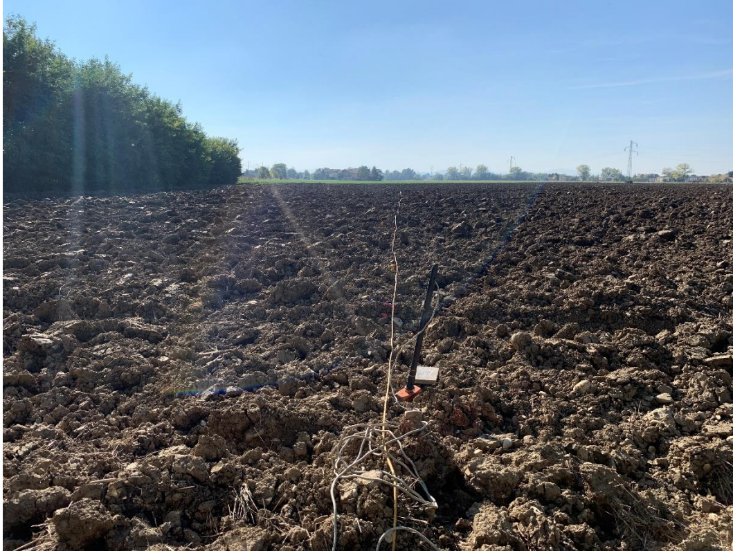
Figura 4.25: Foto relativa all'esecuzione della prova sismica MASW5.
