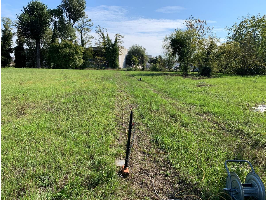
Figura 4.10: Foto relativa all'esecuzione della prova sismica MASW2.
