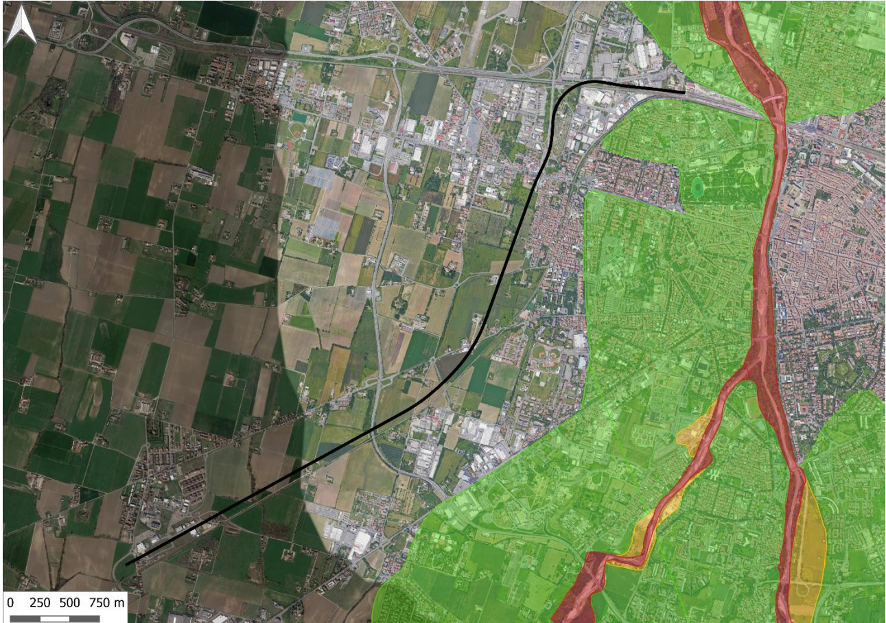
Figura 8-1 - Fasce fluviali stabilite dal PAI - Autorità di Bacino del Po, nei pressi dell'area di interesse (la linea nera indica il tracciato oggetto del presente studio). Legenda: in rosso la fascia di deflusso della piena (Fascia A); in arancione la fascia di esondazione (Fascia B); in verde l'area di inondazione per piena catastrofica (Fascia C).
