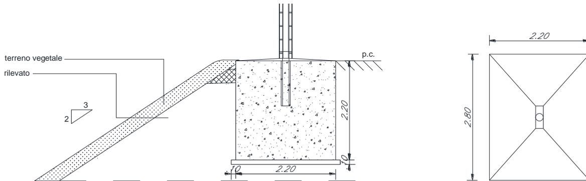
**Figura 1: Soluzione di fondazione diretta in rilevato per paline di segnalamento**
