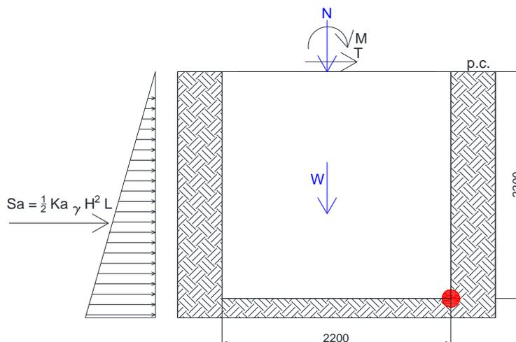
**Figura 4: Schema di calcolo per la verifica al ribaltamento**
