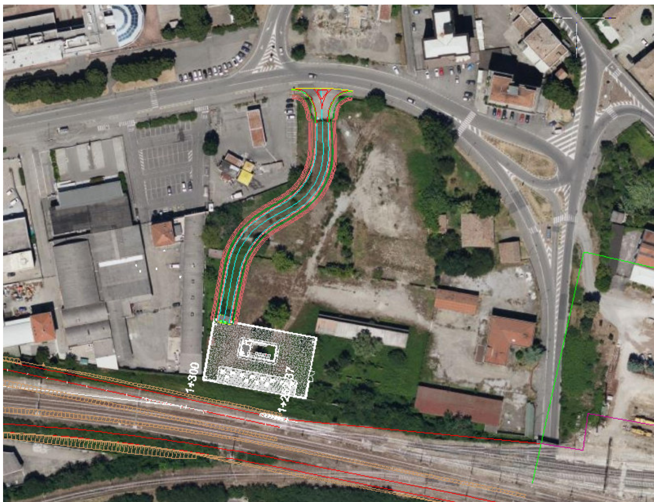
FIGURA 5: NV01 VIABILITÀ DI ACCESSO ALLA CABINA TE
